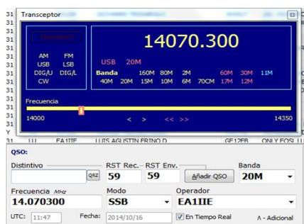
Podremos automatizar nuestros contactos, ya sean en modos digitales o no, mediante el control CAT. Usando la opción de configuración anterior, podremos abrir la ventana de control del Transceptor:
