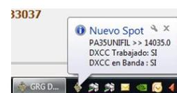
Dentro del Clúster, si contamos con control CAT activo, al presionar dos veces sobre cualquier Spot, automáticamente se enviarán los datos de la frecuencia al transceptor y preparará el sistema para realizar QSO con el Spot deseado.
